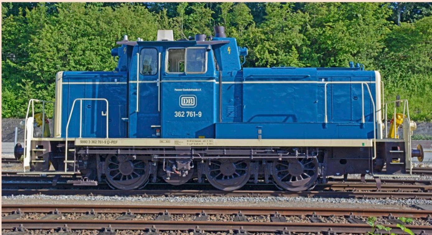
Seit Dezember 2015 ist die 362 761-9 im Eigentum der PEF. In fünf Monaten wurde sie betriebsbereit aufgearbeitet. Auch diese Maschine gehört zu einer Rangierlokombaureihe, die noch von der DB modernisiert und umgebaut wurde. Sie ist bereits mit Rangierkupplung, Funkfernsteuerung und Caterpillar-Motor ausgestattet.
