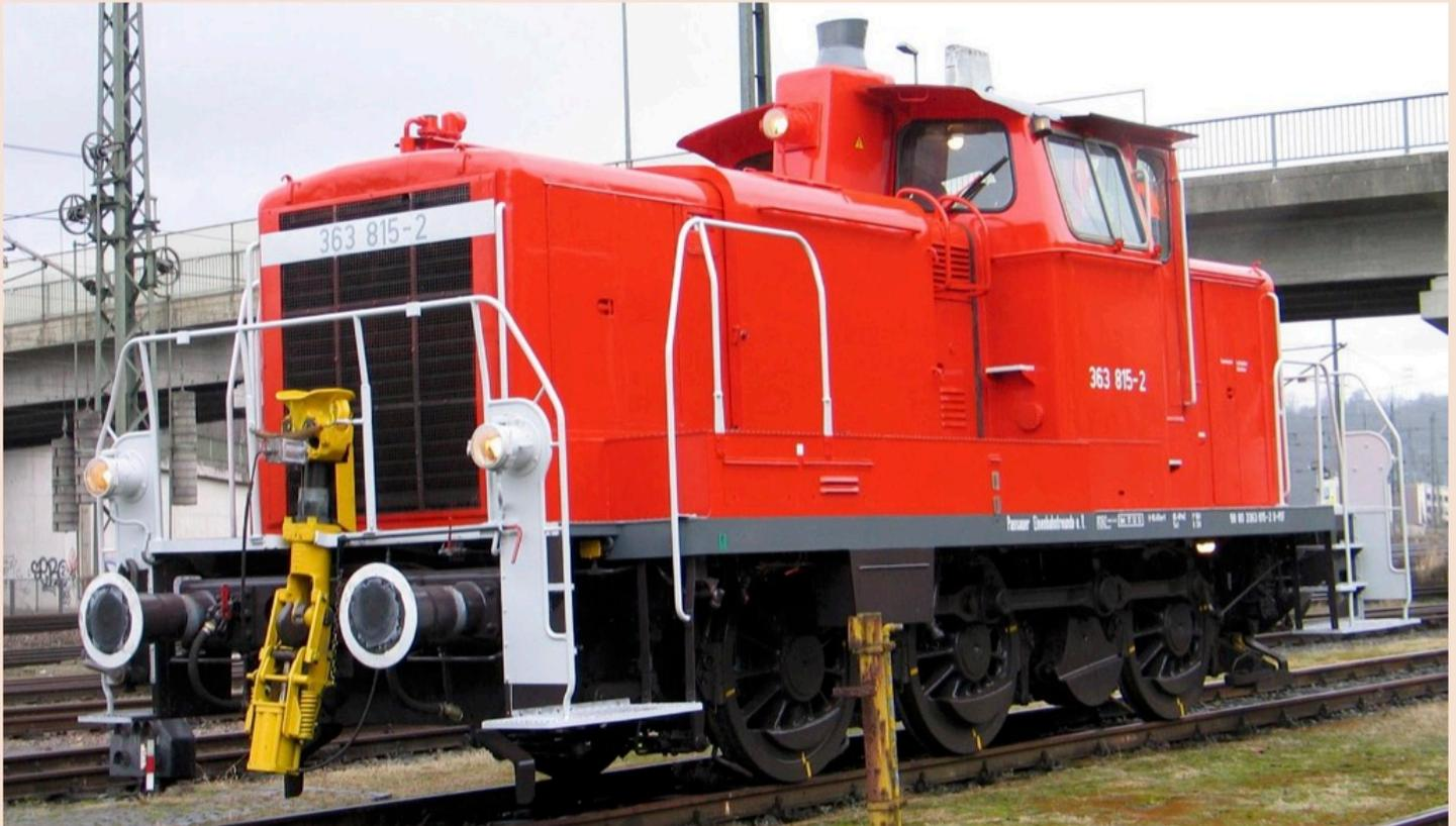
Seit Dezember 2012 ist die 363 815-2 wieder in Betrieb, eine Rangierlokbaureihe, die auch heute noch bei der DB im Einsatz ist. Sie ist bereits modernisiert mit Rangierkupplung, Funkfernsteuerung und Caterpillar-Motor.
