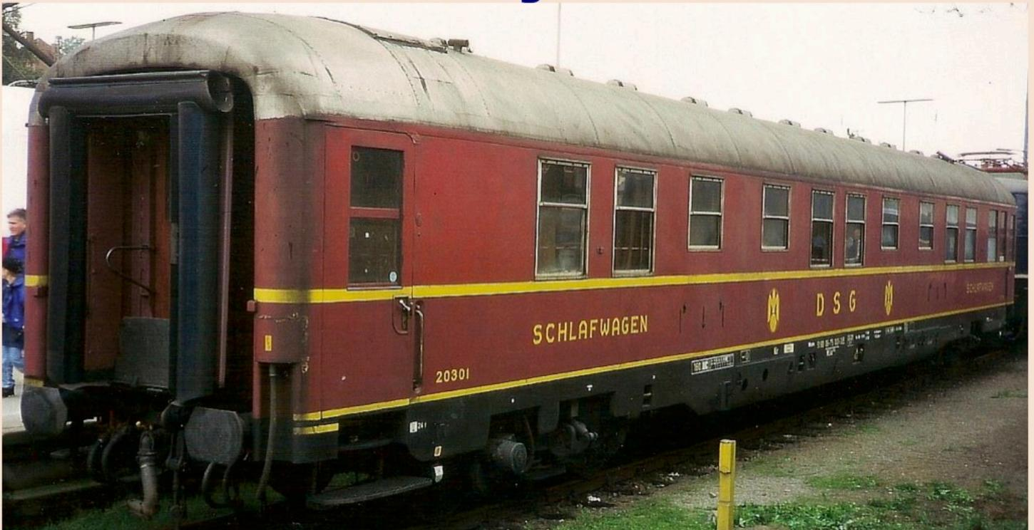
Der Wagen ist der einzig erhaltene so genannte „Zick-Zack-Schlafwagen“, das heißt, dass der Wagen einen Mittelgang hat und die Betten längsseits zur Fahrtrichtung angeordnet sind. Es sind 20 Einzelkabinen mit Waschbecken. Durch die Öffnung einer Trennwand können Doppelkabinen gemacht werden. Der Wagen ist museal abgestellt.
