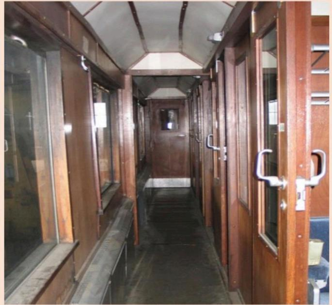
Seitengang zum Zugang für 7 Abteile
