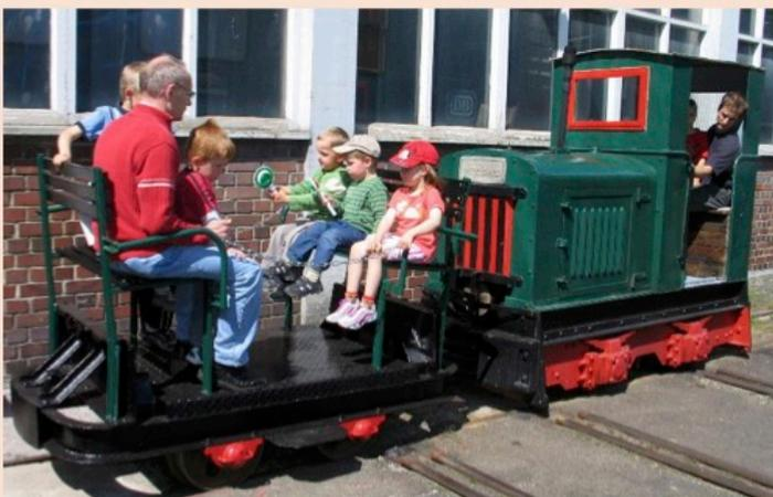
Vor unserer VT-Halle verlaufen Feldbahngleise mit einer Spurweite von 600mm. Diese wurden einst für den Transport von Radsätzen vom Außenlager in die Halle verwendet. Vor der Eingangstüre befand sich eine Feldbahndrehscheibe, um im Winkel von 90° in die Halle fahren zu können. Heute stehen am Eingang eine Feldbahnlok der Fa. Gmeinder und eine Lore, die bei besonderen Anlässen zur Freude der Kinder fährt.
