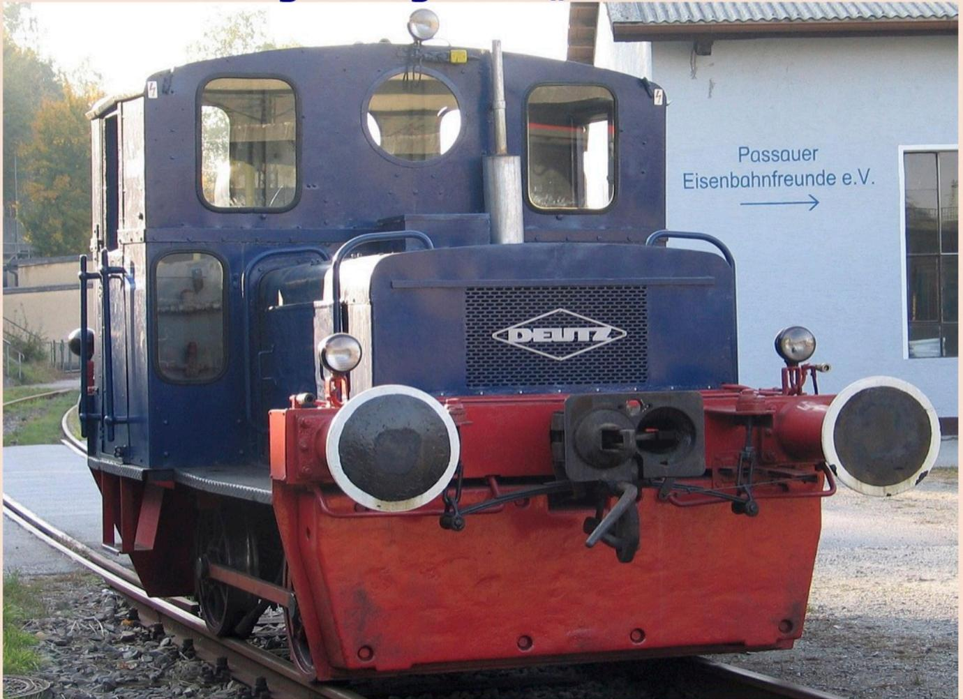
Der „Auerhahn“ war einst Werkslokomotive in den Stahlwerken Peine-Salzgitter und rangierte Erzwagen mit Mittelpufferkupplung in die Werkstatt. Luftgekühlter Deutz-Motor mit 21KW/28PS für 13km/h
