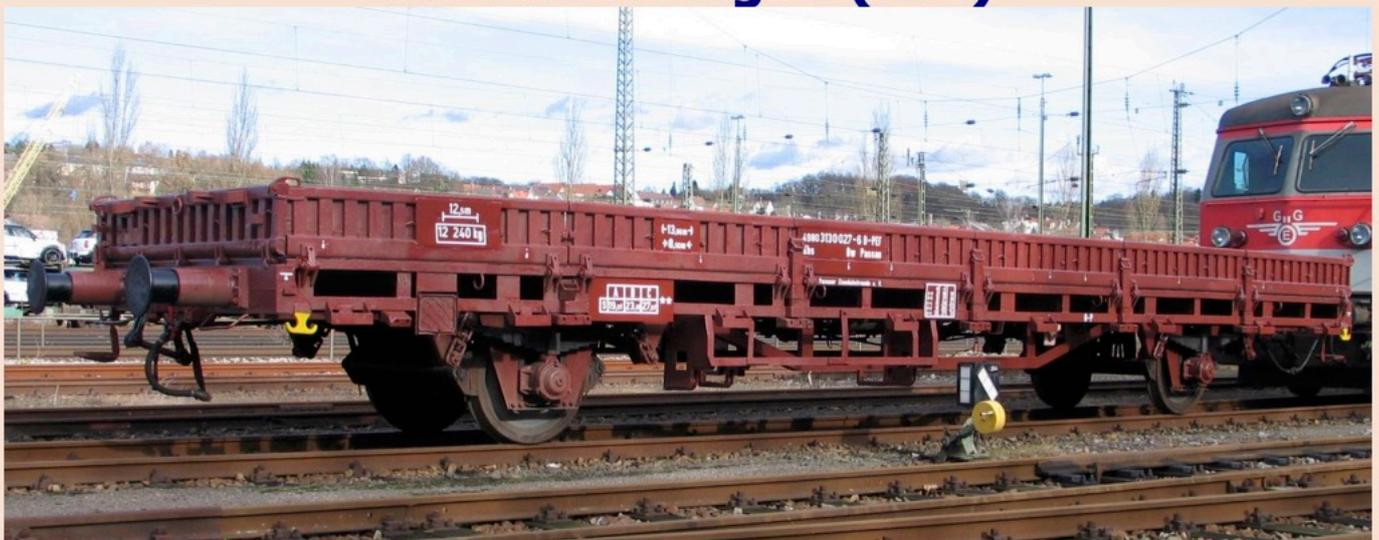
Auf Niederbordwagen (Kbs-Wagen) können über Kopframpen Fahrzeuge aufgeladen werden, z.B. Bagger oder Ausschneidegeräte für Vegetationsbeseitigung. Auch dieser Wagen wurde restauriert einschließlich Neulack.
