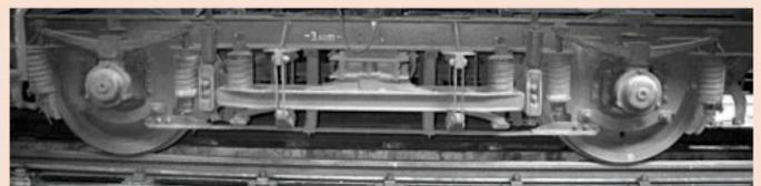
Der Wagen ist ausgerüstet mit Görlitz III-Drehgestellen leicht mit 4. Federung, links die Zeichnung und rechts das Original des A 308 im Zustand 2012. Die Laufruhe dieser Wagen ist beeindruckend.
